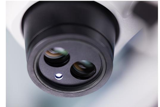
*Stemi 305 ist mit einer integrierten, fast vertikalen LED-Beleuchtung ausgestattet, die Löcher und Kerben ausleuchtet – auch durch eine Frontoptik.*
