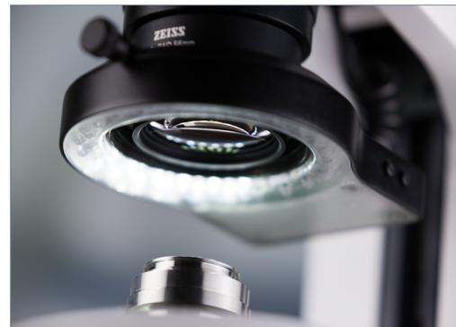
*Das schattenfreie Ringlicht bietet vier verschiedene Modi: Voll-, Halb-, Viertelkreis oder zwei gegenüberliegende Viertelkreise. Wird das Ringlicht eingeschaltet und die Beleuchtungsrichtung manuell in 90°-Schritten gedreht, lassen sich Kratzer, Defekte oder Rückstände schnell untersuchen, ohne dafür die Probe bewegen zu müssen. Im automatischen Rotationsmodus erhalten Sie durch wechselnde Schatten einen räumlichen Eindruck von der Objektoberfläche.*
