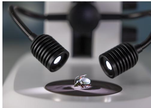
*Für die Probenpräparation im Auflicht ist die Doppelspot-Beleuchtung mit selbsttragenden Schwanenhälsen optimal. Sie erzeugt Halbschatteneffekte für einen guten dreidimensionalen Eindruck ohne allzu dunkle Schatten. Bei der Dissektion bleibt die Probe auch dann ausgeleuchtet, wenn die manipulierende Hand einen der Spots verdeckt.*
