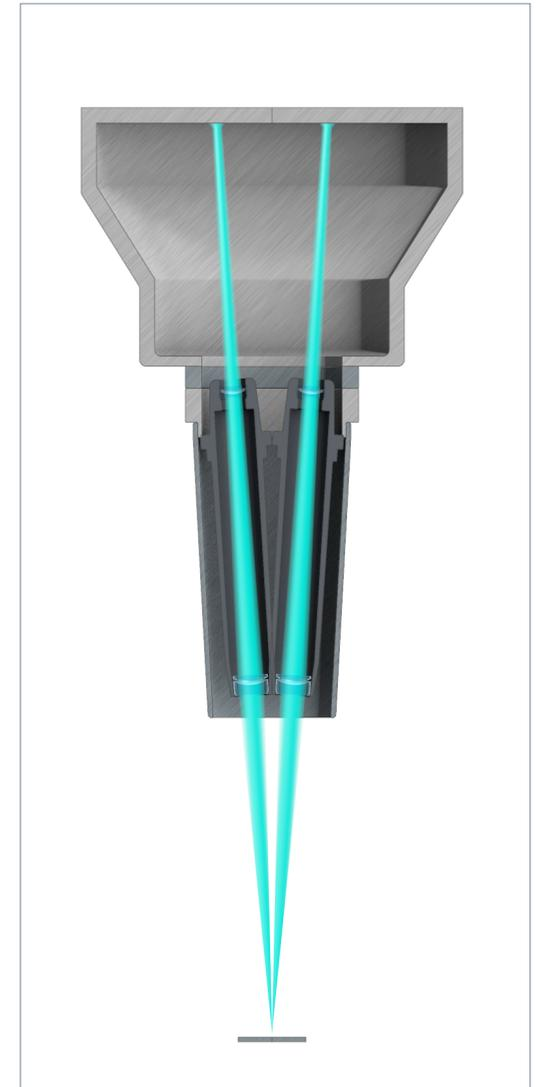
Strahlengang eines Greenough-Stereomikroskops
