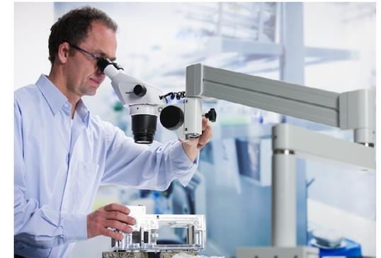
*Für große Proben oder breite Interessensbereiche bieten wir verschiedene Auslegerstative: Stativ A mit Einzelausleger, das kugelgelagerte Stativ SDA für besondere Stabilität und leichte Beweglichkeit oder das in der Höhe ausbalancierte Schwenkarmstativ U für die Beobachtung großer Probenvolumina. Mit der 0,5x-Frontoptik profitieren Sie von einem Arbeitsabstand von 185 mm.*
