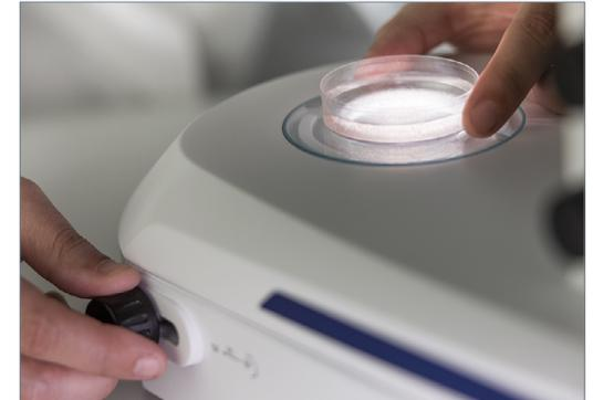
*Der kipp- und verschiebbare Spiegel bietet die Optionen Hellfeld, einseitiges Dunkelfeld und Schräglicht – und wahlweise auch Polarisationskontrast. Durch Drehen können Sie zwischen der satinierten und der regulären Spiegelseite und damit zwischen gestochen scharfem und diffusem Hellfeldkontrast wählen.*
