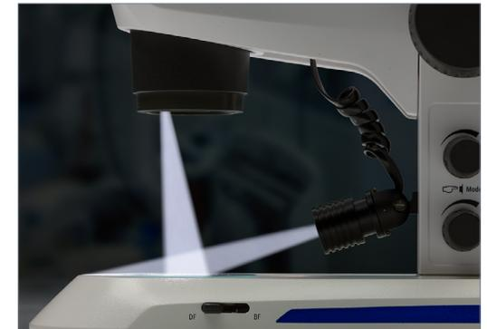
*Auf Knopfdruck wechseln Sie zwischen vertikaler Beleuchtung, Schräglicht-Spot und Mischlicht und regulieren die jeweilige Lichtstärke.*
