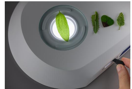
*Verwenden Sie die flache Durchlichteinheit, um farbige transparente Proben im Hell- und Dunkelfeld kontrastreich darzustellen. Mit dem optional erhältlichen Polarisor-/Analysatorzubehör können doppelbrechende Kristalle oder Spannungen in Glas oder Kunststoff betrachtet werden.*
